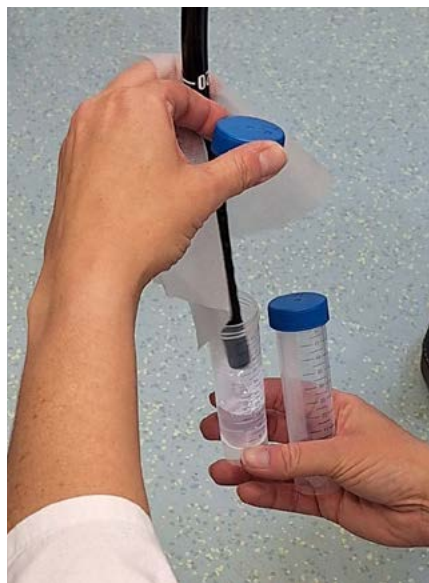
Auffangen der Durchspül-Flüssigkeit in je einem sterilen Probenröhrchen.
