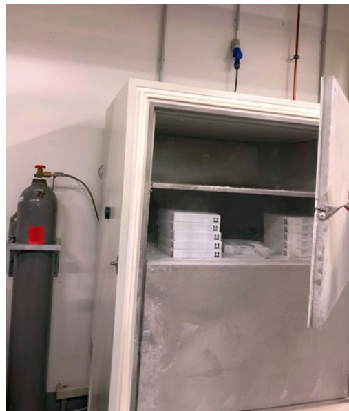
Geöffneter Ultratiefkühler mit Corona-Impfstoff beim Arzneimittelgroßhandel AHD. Das Gerät ermöglicht eine Lagerung bei -90 bis -60 °C.
